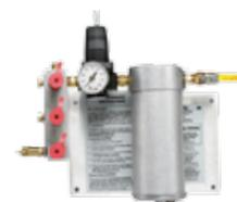
W-2806 过滤水、油、微粒，调节空气压力，分配流量
